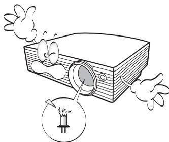
9. Non sostituire il complesso lampada o qualsiasi altro componente elettronico quando il proiettore è collegato alla presa di alimentazione.
