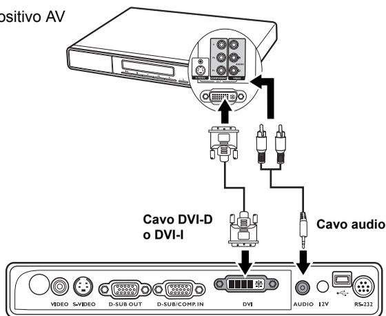
**☞ Nel caso in cui collegando il proiettore a un lettore DVD tramite l'ingresso DVI-D del proiettore le immagini vengano visualizzate con i colori errati, cambiare lo spazio colore su YUV. Per ulteriori informazioni, vedere ["Modifica dello spazio colore" nella pagina 34.](#)**
