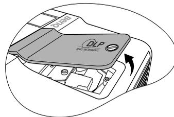
4. Allentare la vite di fissaggio del coperchio della lampada.
