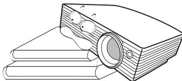
16. Non collocare l'unità in posizione verticale. Così facendo si può causare la caduta dell'apparecchio, che provocherebbe lesioni all'operatore o danni all'apparecchio stesso.
