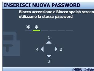
Quando **Blocco spalsh screen** viene attivato, la funzione **My Screen** nel menu **CONFIGURAZ. SISTEMA: Di base** sarà protetta da password.
