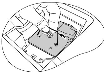
6. Come mostrato in figura, per prima cosa far scendere la nuova lampada all'interno del connettore sul proiettore e allineare i due fori sulla lampada con quelli posizionati sul proiettore.
