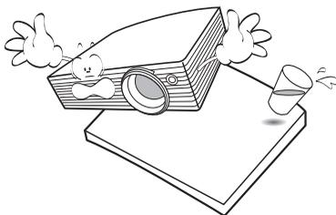
11. Non tentare di smontare il proiettore. L'alta tensione presente all'interno del dispositivo potrebbe essere letale in caso si venisse a contatto con parti scoperte. L'unica parte riparabile dall'utente è la lampada, dotata di un coperchio estraibile.
