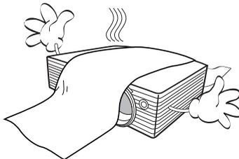
Se i fori di ventilazione sono ostruiti, il surriscaldamento del proiettore può provocare un incendio.
